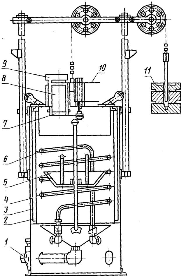
1—сливной патрубок; 2—реактор; 3—колокол; 4—водяной затвор; 5—перфорированный поддон; 6—охлаждающий змеевик; 7—заслонка; 8—загрузочная камера; 9—колпак; 10—поворотное устройство; 11—груз.
